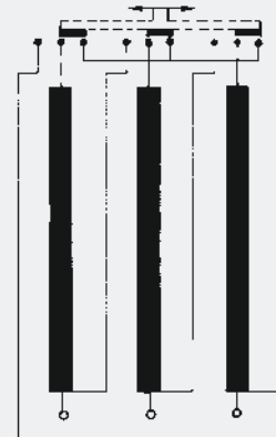
Stern-Dreieckschaltung Star-delta coupling
