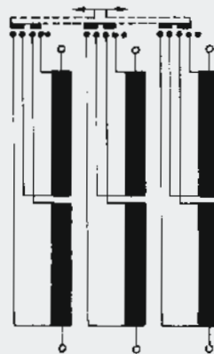
Serien-Parallelschaltung Series-parallel coupling
