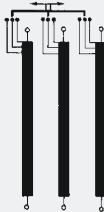
Sternschaltung für Transformator Setting for star transformer
