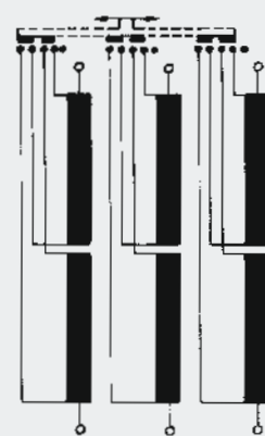
Serien-Parallelschaltung Serielle-parallel coupling
