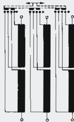
Serien-Parallelschaltung Series-parallel coupling
