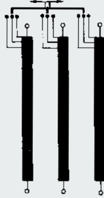
Sternschaltung für Transformator Setting for star transformer
